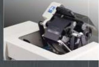
採用轉盤設計，以方便拆裝包裝袋，AutoThread 功能可簡化包裝袋的更換作業
